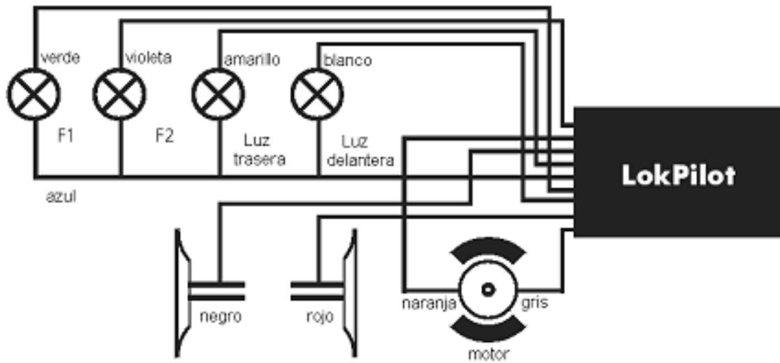
Fig. 2 – Cableado del LokPilot con funciones aisladas
