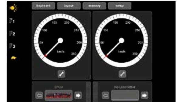
Coloque la locomotora con el decoder mfx sobre la vía de programación. Esto puede hacerse también con otras locomotoras en circulación. La locomotora se da de alta conforme a las siguientes figuras. Es posible dar de alta la locomotora bien con su imagen o también sin ellos. En función de cómo se dé de alta la locomotora, será necesario un repaso, como se describe a partir de la página 13.
